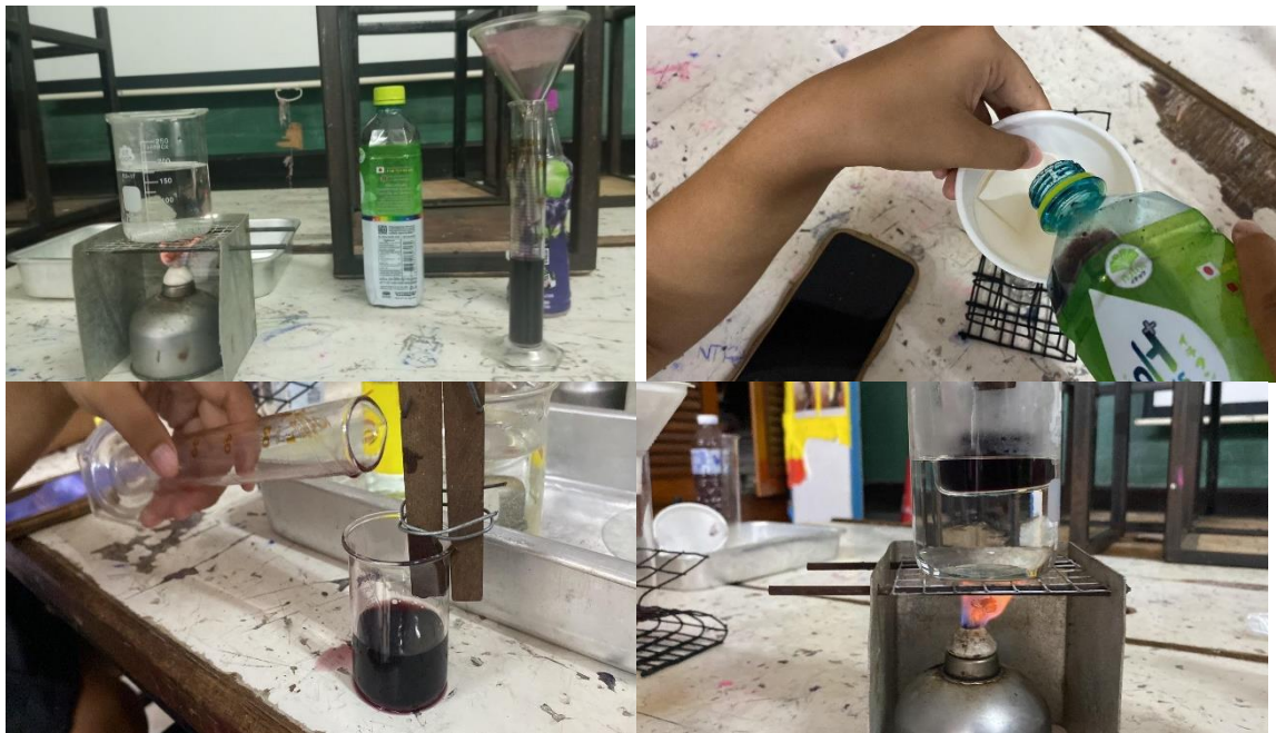
รูปที่ 8 กระบวนการสกัดสีจากข้าวไรซ์เบอร์รี่
